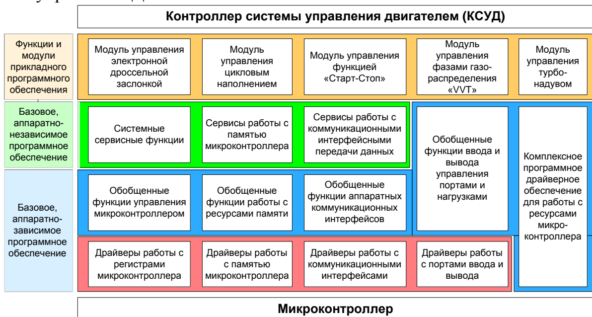
Рисунок 2 – Концепция архитектуры программного обеспечения КСУД
